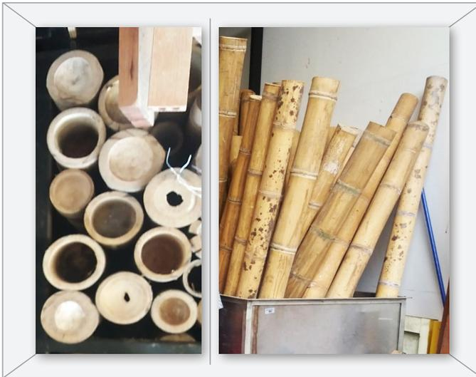
**Figura 15. Correcta disposición en almacenamiento de la guadua. Apilamiento con 5 culmos. (izquierda), almacenamiento vertical para evitar la humedad (derecha). Fuente: Sánchez, 2019**
