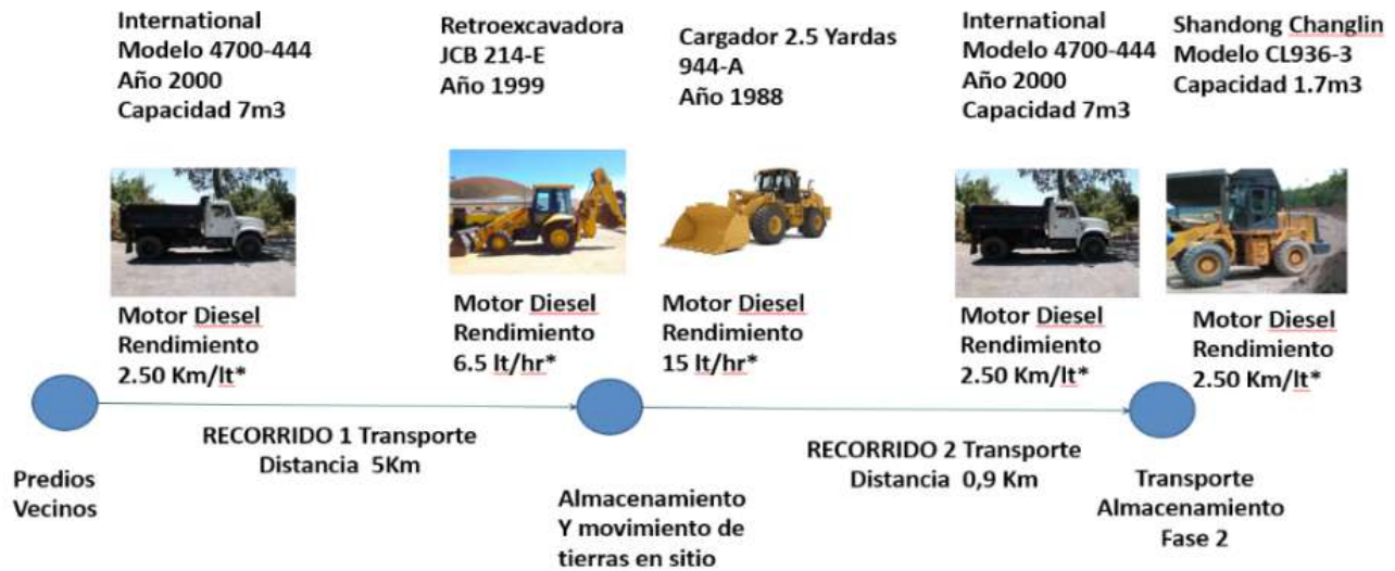
Figura 8. Análisis de la maquinaria utilizada en el proceso “Extracción y maduración de la arcilla a cielo abierto”, de acuerdo con su rendimiento y características. Fuente: Elaboración propia.
