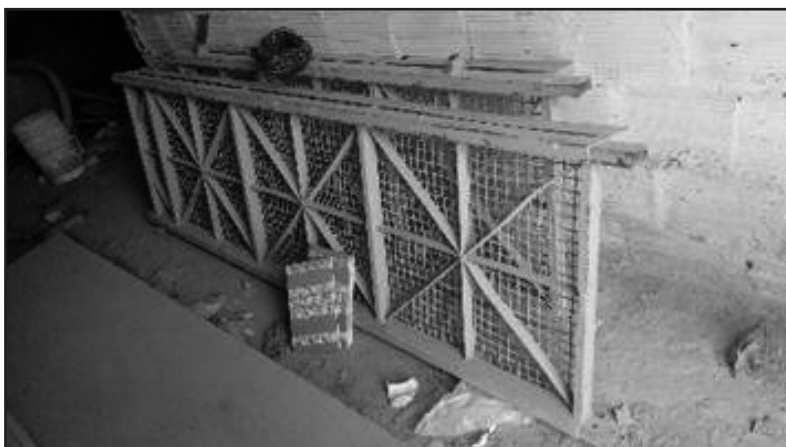
Figura 18. Plataforma Andamio colgante. Sobraron 2 unidades. Fuente: López J., 2018.
