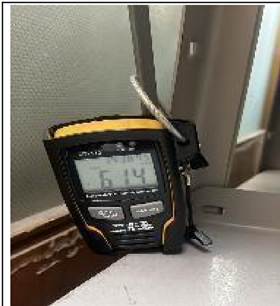
Instalación del Sistema de medición de condiciones ambientales-Datalogger-División Administrativa
