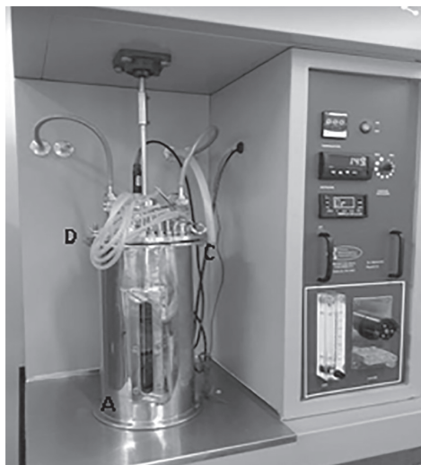
Figura 20. Biorreactor Tecferm de 5 L donde se observa a. mirilla lateral, b. aro de cierre, c. tapa tipo head plate y d. vaso inoxidable
